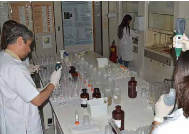
Análises de parâmetros químicos das amostras de água dos quatro pontos de coleta. Lab. de Hidrobiologia – UFRJ, 21/09/11. Coordenada pelo professor Rodolfo Paranhos, a equipe executa uma dezena de análises imediatamente após a coleta no mar. Foto: Fernando Moraes.
