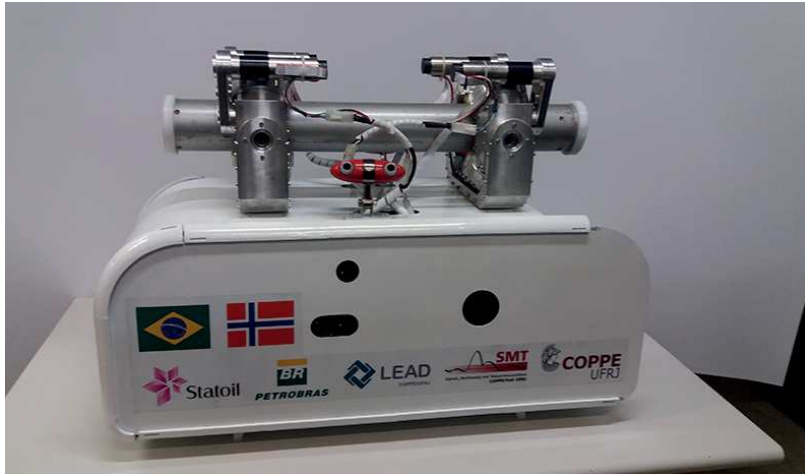
Acima, a partir da esq., o robô Doris, produzido para monitorar plataformas de petróleo, a fim de evitar acidentes e perdas de produção;...
