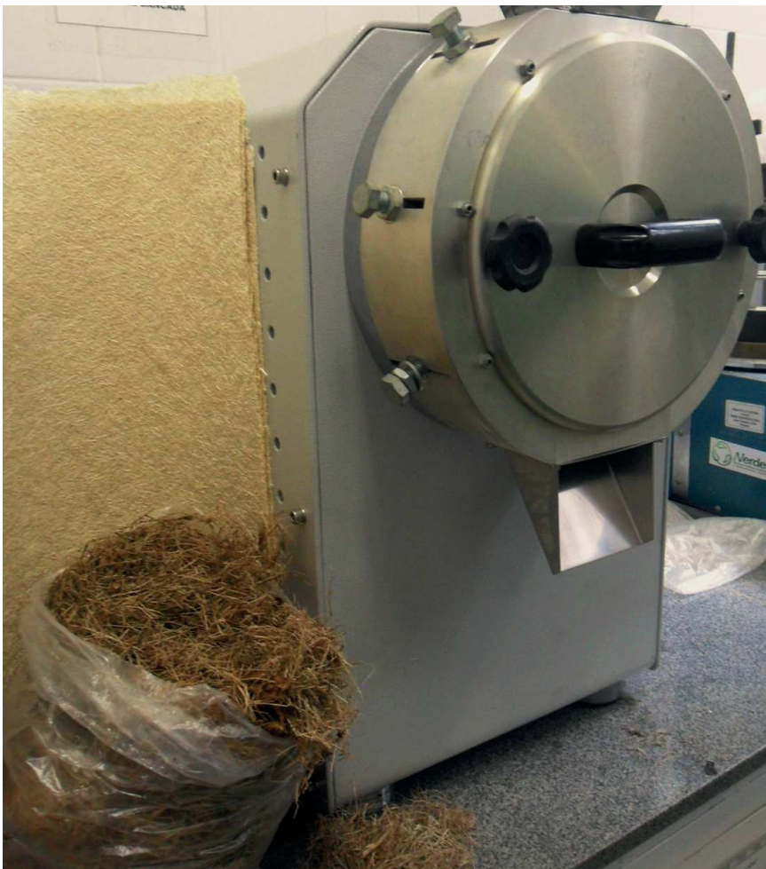
No Laboratório de Misturas Poliméricas do IMA/UFRJ, as fibras de palmito pupunha viram placas, que depois recebem polímeros
