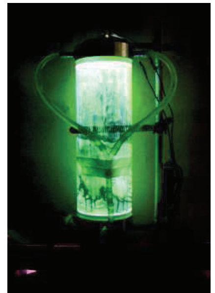
O reator: fonte de luz ultravioleta e catalisador agem para obter água limpa
