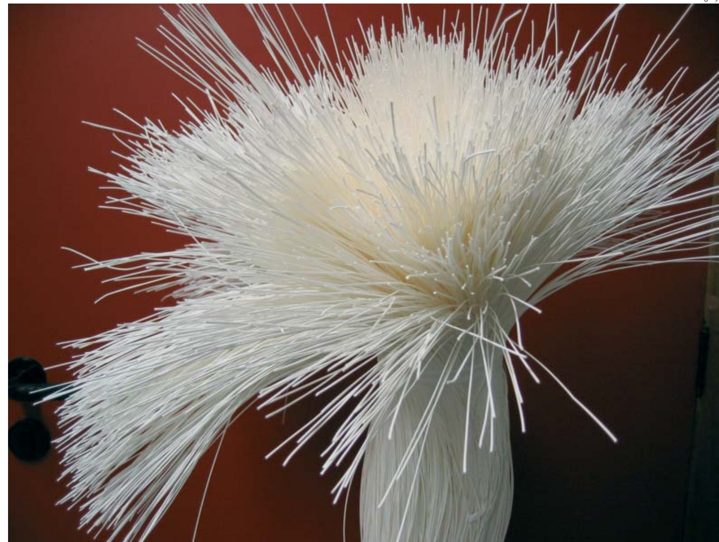
Membranas usadas em sistema de microfiltração: tecnologia de baixo custo no tratamento e reúso de água
