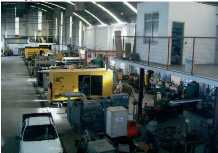
Linha de produção de geradores da Locastrom: motores convertidos para utilizar óleo vegetal com a ajuda de tecnologia da alemã Elsbett, adaptada por Lamers e Felicíssimo
