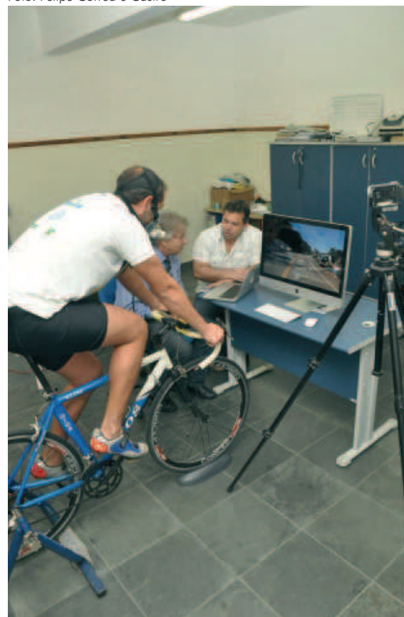
Atleta durante treinamento de esforço físico com o “rolo”: aparelho possui um software por meio do qual é possível simular diversas competições, pedalando sem sair do lugar
