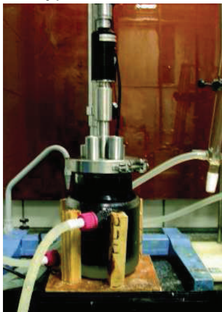
Reator no Laboratório de Biopolímeros e Sensores da UFRJ: equipamento onde a maghemita é obtida sob condições controladas de temperatura e agitação. Estudo, coordenado por Fernando Gomes de Souza Júnior, propõe resina de baixo custo de implantação
