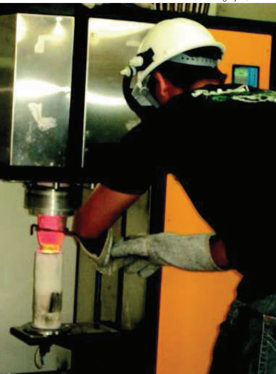
Etapa de fabricação de vidro ecológico: análise das temperaturas de fusão das misturas
