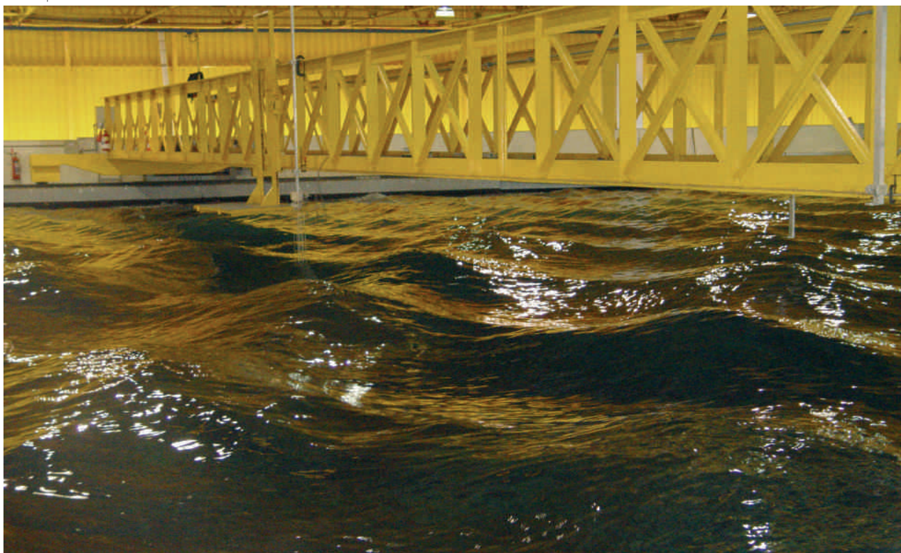
O tanque oceânico da Coppe é utilizado para simular as principais características do ambiente marinho e fenômenos que ocorrem em águas profundas
