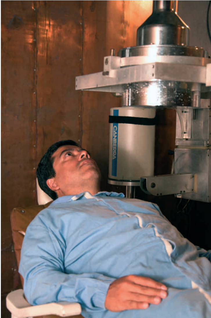
Equipamento no IRD é capaz de avaliar a quantidade de elementos radioativos no corpo de pacientes: resultado do edital Apoio a grupos emergentes de pesquisa
