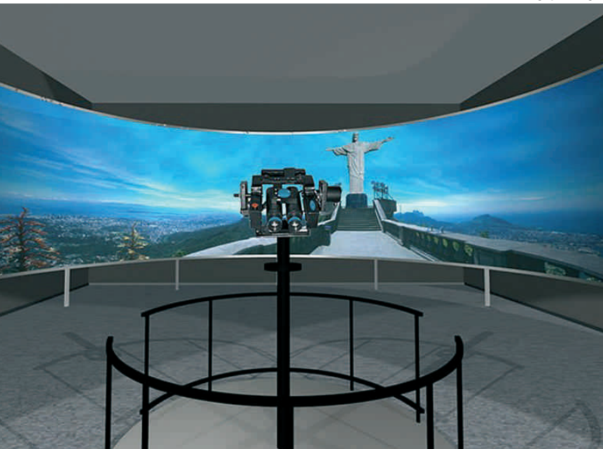
O Visorama, resultado do edital Rio Inovação : o dispositivo produzido pela UFRJ e Impa simula um binóculo eletrônico, que permite ao usuário interagir com um panorama virtual da cidade
