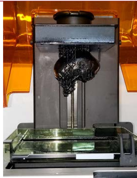
Etapa do processo de impressão em 3D da réplica do crânio de Luzia, o fóssil humano mais antigo encontrado na América do Sul
