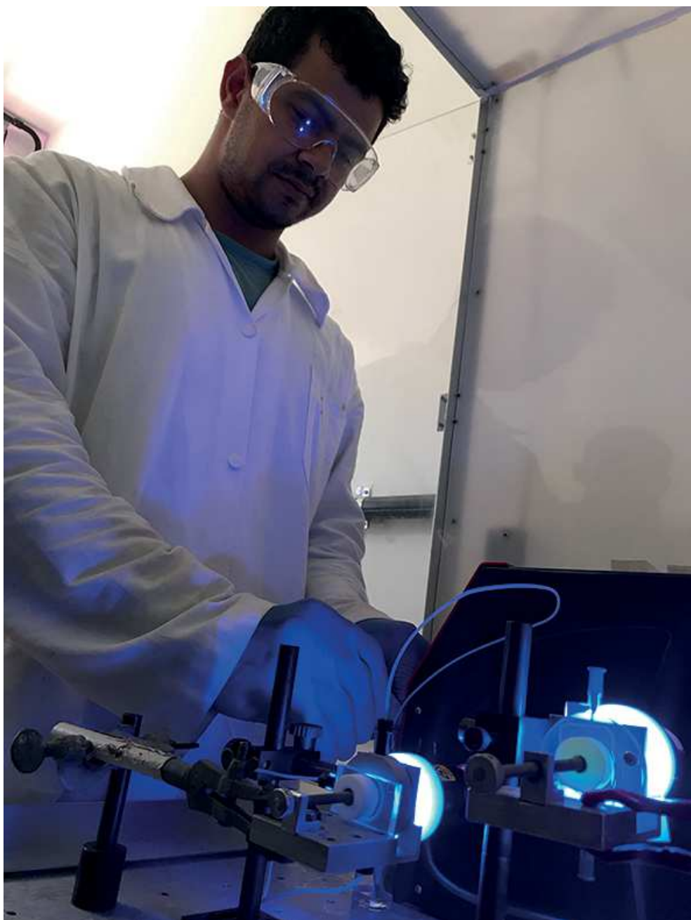
O desenvolvimento de microrreatores também foi o tema da tese de doutorado de Druval Santos de Sá. Na foto, ele realiza teste de velocidade da degradação de componentes orgânicos
