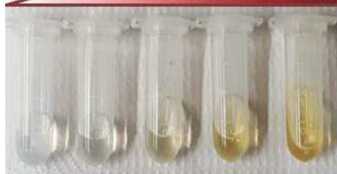
Esquema demonstra a relação da concentração do metal com a substância produzida pela levedura geneticamente modificada
