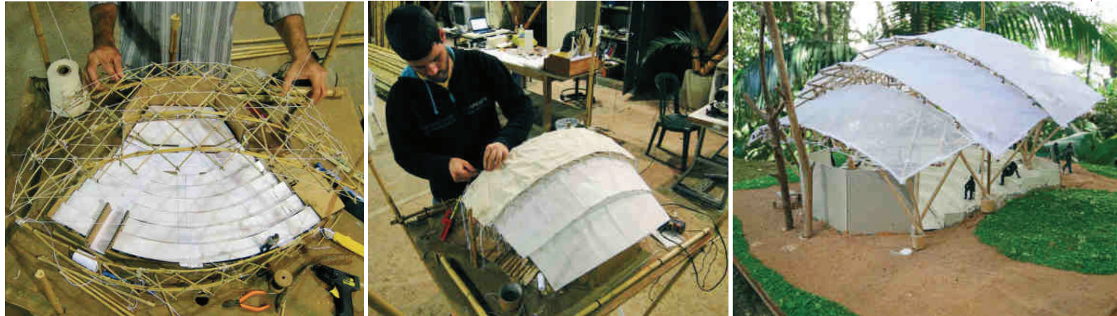
Processo de montagem de maquete de cobertura para anfiteatro: à esq., na etapa inicial, a estrutura treliçada de bambu; no centro, a modelagem do domo em formato de concha, com propriedades acústicas e de proteção às intempéries; à dir., o modelo em escala 1:50
