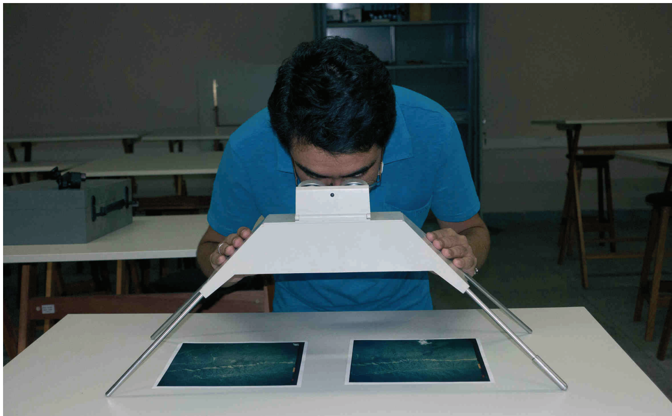
Estereoscópio de espelho: equipamento é utilizado para fazer a interpretação, em 3D, das fotografias aéreas do relevo da área estudada
