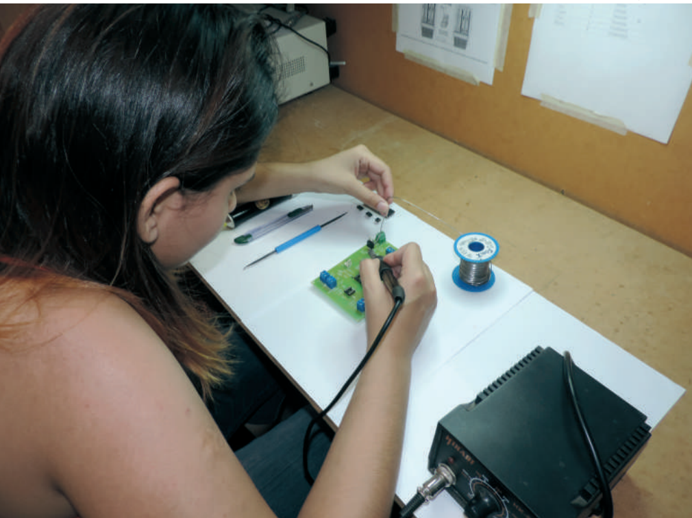
Montagem do Kit Mesh Solar: placa controla carga energética e permite a medição e o transporte, por rede, de dados sensoriais, como temperatura e níveis de luz
