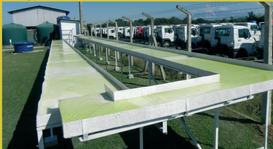
Fotobiorreator por onde circula a água com microalgas: biomassa resultante do processo é usada na produção de biodiesel
