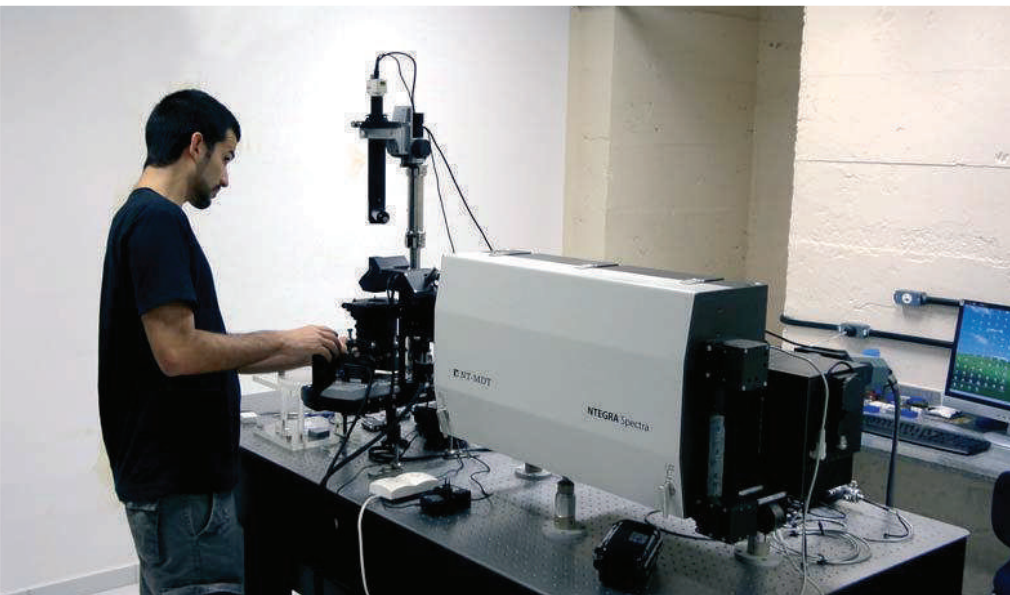
O estudante de mestrado Gil Capote, da PUC-Rio, opera o microscópio e espectrômetro Raman: caracterização ótica de amostras de grafeno produzidas na própria instituição
