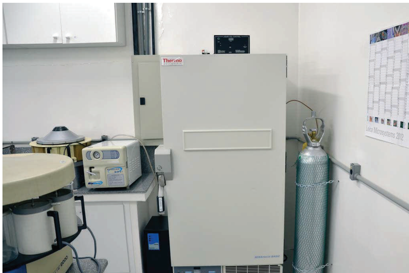
Ultrafreezer adquirido com recursos da Fundação: material genético é armazenado a baixíssimas temperaturas, de até 80° C negativos
