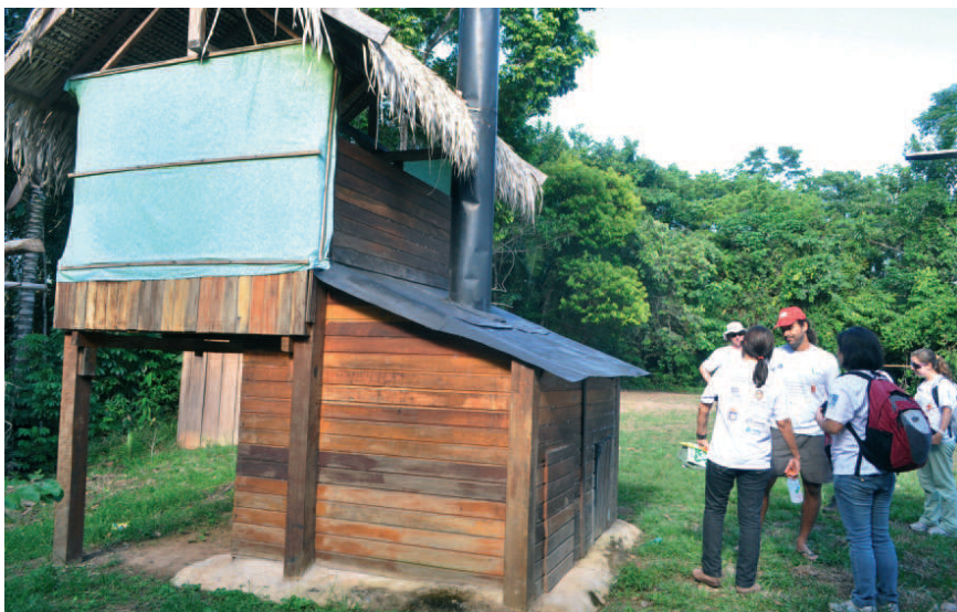
Tecnologia verde: no banheiro seco, água é substituída por camadas de folhas e os dejetos podem ser empregados como adubo
