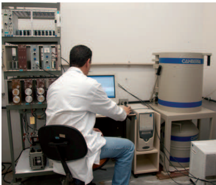
A pesquisa em diferentes etapas: à esq., sala de instrumentação do Laboratório de Bioanálises do Instituto de Proteção e Dosimetria (IRD); à dir., sistema de espectrometria gama mede a quantidade de elementos radioativos em amostras de urina de pessoas submetidas à radiação
