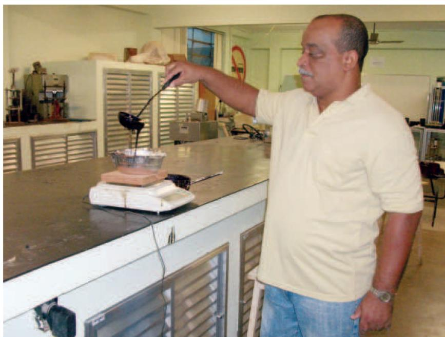
*Teste de resistência do asfalto com bagaço de cana no laboratório do IFF (no alto). Ao lado, Cláudio Leal adiciona o ligante asfáltico durante o processo de fabricação*
